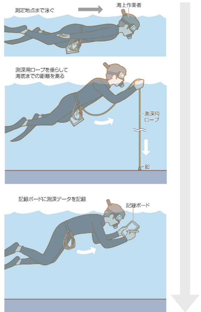
図3 ロープを用いた測深のイメージ
